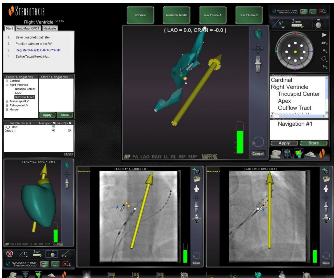
Figura 1 Imagens fluoroscópicas de referência no ecrã do Navigant em OAE e OAD, mostrando em tempo real a posição do cateter de ablação (estrela preta) sem recurso à fluoroscopia; o vetor automático do SNM apontando à CSVD (vetor amarelo) e feixe de His marcado (pontos amarelos). CSVD: câmara de saída do ventrículo direito; OAD: oblíqua anterior direita; OAE: oblíqua anterior esquerda; SNM: sistema de navegação magnética.
